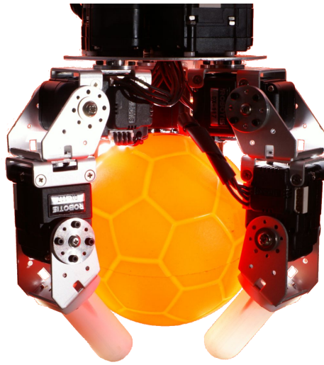
Figur 1.4: Prototype af tre-fingret griber med ni frihedsgrader, tre per finger. (Kilde: http://www.flickr.com/photos/psinewave/1354728851 )
