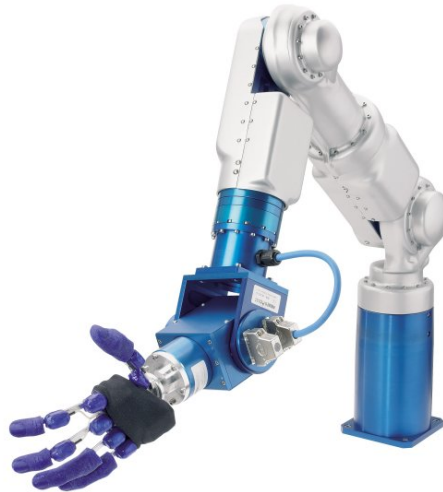
Figur 1.3: En mangeakset hånd påmonteret en robot. (Kilde: Amtec Robotics)
